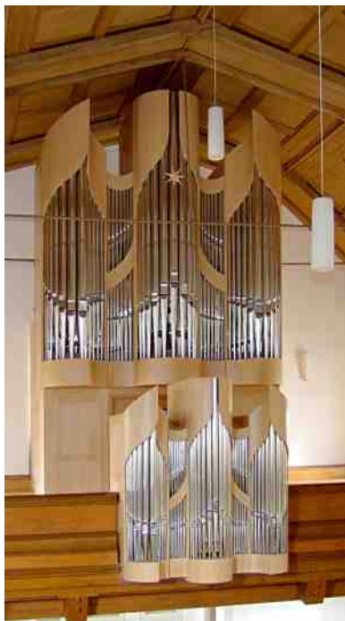
Mechanische Spiel- und Registertraktur von Orgelbau Heintz, Schiltach – OBM Klaus Schleinitz – erbaut
